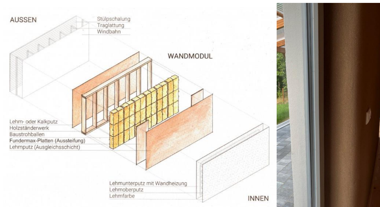
Figur 25. Till vänster: Väggmodulens uppbyggnad. (Bildkälla: Stroh-lehm-haus 2024) Till höger: Färdig yttervägg.
