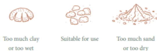
Figur 9. Guide för testmetod i fält (Rustas 2023)
