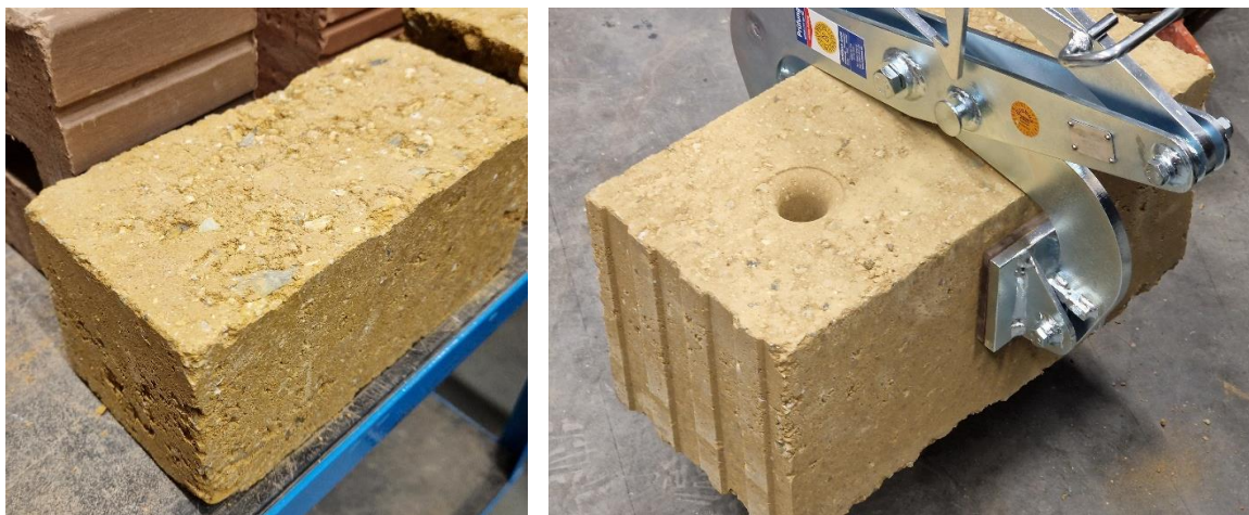
Figur 32. Lersten, "CEB" (Compressed earth block)
