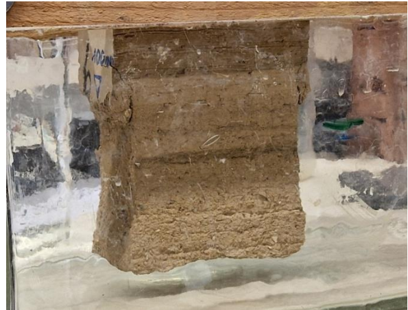
Figur 35. Erosionstest enligt DIN-standard.
