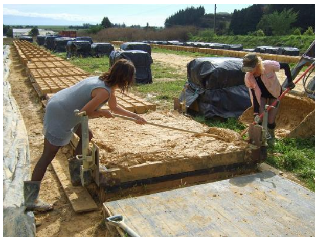
Figur 5. Tillverkningsmetod adobe-tekniken. (Bildkälla: Solid earth 2024)
