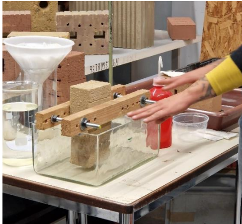
Figur 34. Erosionstest enligt DIN-standard.
