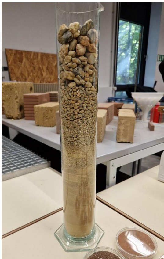
Figur 33. Exempel på kornfördelning till en lersten (CEB).
