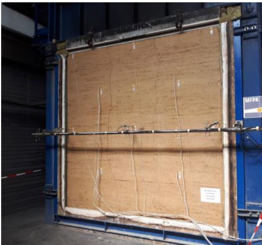
Figur 18. 100 minuters brandtest för 22 cm vägg. (Bildkälla: Waigand 2024)
