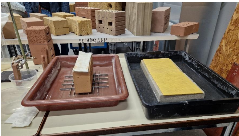
Figur 36. Test av fuktabsorption enligt DIN-standard.
